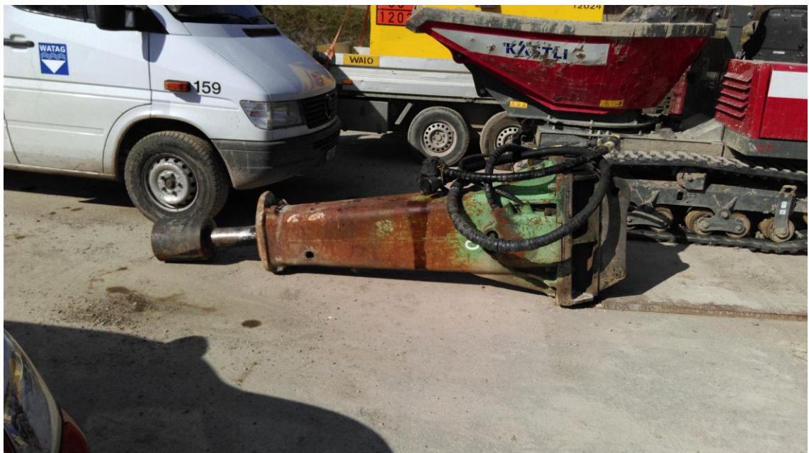
Foto des Rammhammers (Foto Kästli Bau AG)
